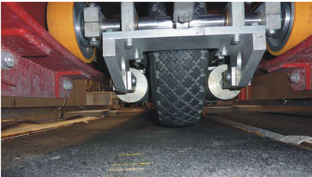
Abbildung 4: Unterer Bereich der Prüfmaschine MMLS3.
